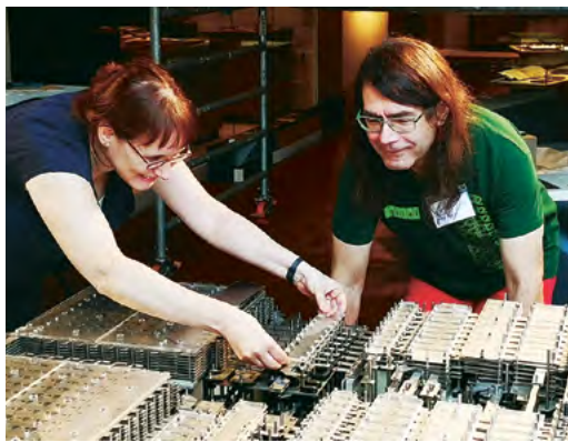
Eva Kudraß und Klemens Krause entfernen vorsichtig ein Bauteil des Speicherwerks des Z1-Nachbaus. (Rainer Siebert)
