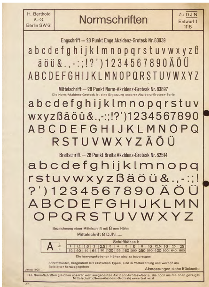
Aus dem DigiS-Projekt „Cut, Paste, Edit“: Entwurf zu einer DIN-Norm 1118 – „Normschrift“ mit der Akzidenz-Grotesk-Serie als Vorlage (1925). (SDTB/ Historisches Archiv)
