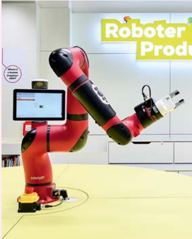
Der Cobot Sawyer kann sehr präzise greifen und ist ein Vorführobjekt.
